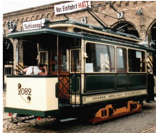
Elektrischer Triebwagen Typ Alt-Berolina der Großen Berliner Straßenbahn, Baujahr 1901
